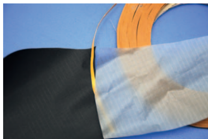
Klebeband hilft ungemein beim Zusammenfügen der Paneele
