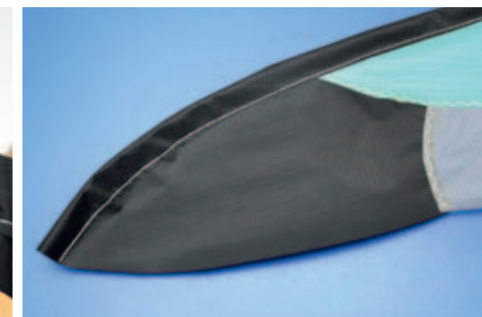
Zwei Streifen werden zunächst zusammengenäht, dann umgekrempelt und mit dem Segel vernäht
