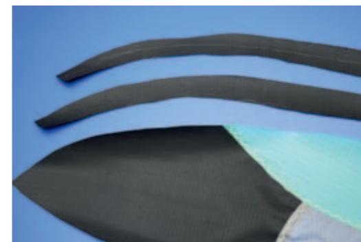
Zwei Streifen werden zunächst zusammengenäht, dann umgekrempelt und mit dem Segel vernäht
