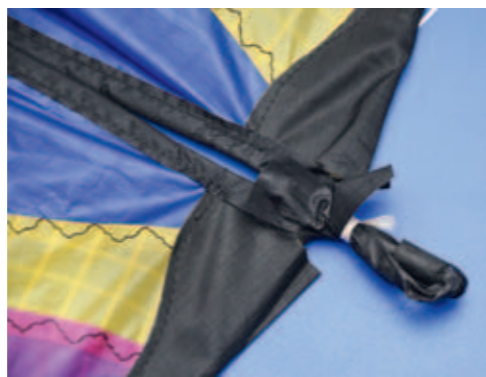
Überschüssiges Saumband wird durch die Splittkappe gezogen und mit einer Stabendkappe gesichert
