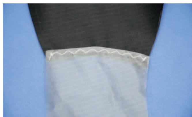
Dreifacher Zickzackstich bei den Paneelen; wer mag, kann auch eine Segelmachernaht nehmen
