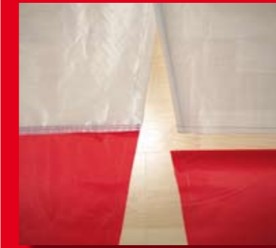
Die beiden Paneele werden mit einfacher Kappnaht zusammengenäht
