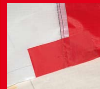
Verstärkungen sitzen ebenfalls an der Nahtstelle zwischen den Segeln
