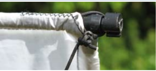
Aufhängung der Spannschnüre am Ende des oberen Querstabs
