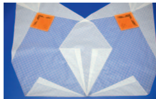
Zwei Segelsegmente werden zusammengefügt
